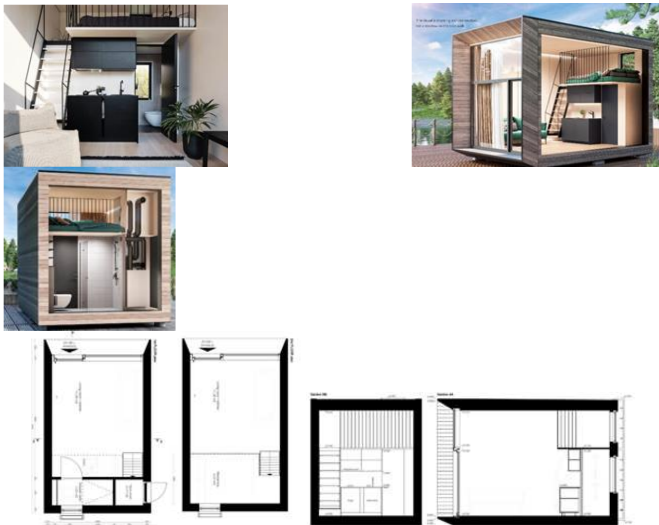
Фиг. 3. KODA , арх. Kodasema ; поглед отвътре и външни изгледи с частично отрязани стени - горе.; разпределения и разрези - долу; източник: https://kodasema.com/en/
