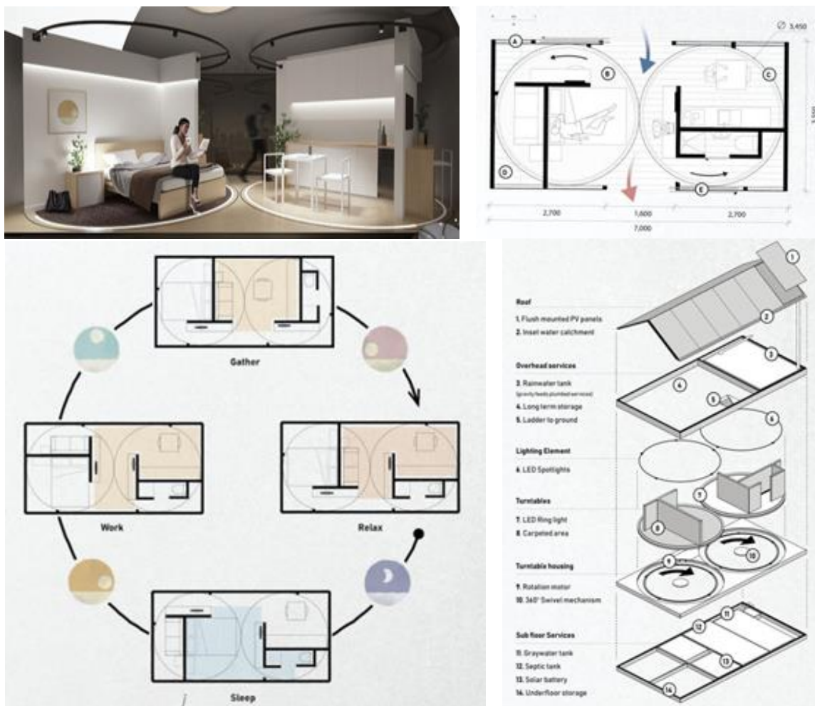
Фиг. 7. Revolve, арх. Damien Lees; разпределения и разрези - горе; схеми на възможните функционалности и аксонометрия - долу; източник: https://architecturecompetitions.com/microhome4/
