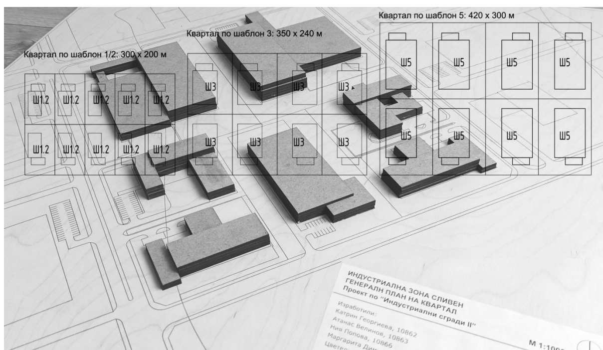
Фиг. 3. Теоретико-приложна схема за планиране на генерален план на индустриална територия на равнище квартал и група квартали
